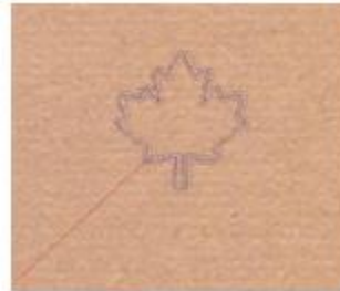
Fig. 3.11 Se muestra la vista previa de los vectores y la ruta que seguirá el cortador
