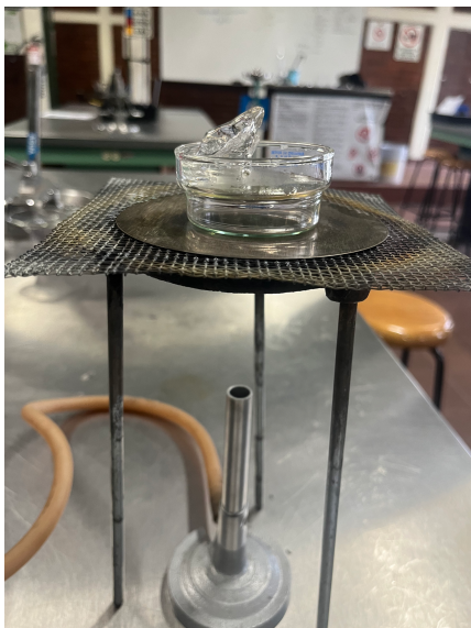
Fig. 2.2 Dispositivo de sublimación y condensación del yodo. Elaboración propia para fines académicos
